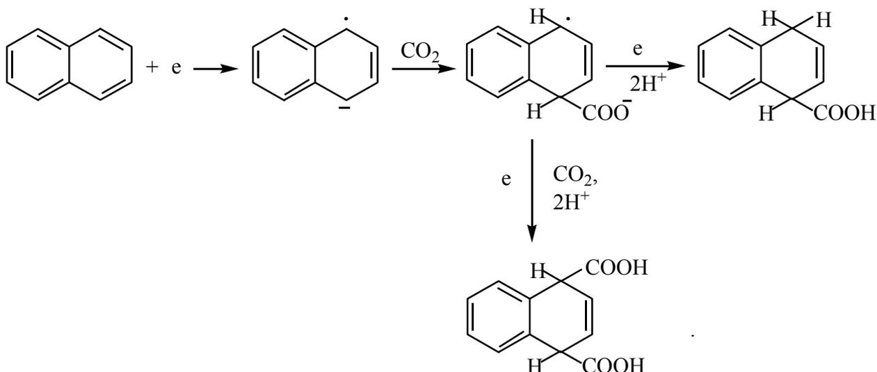
T. Osa и Y. Shinzaki [88] провели электрокарбоксилирование 1- и 2-цианонафталинов до соответствующих тетрагидродикарбоксильных производных:
