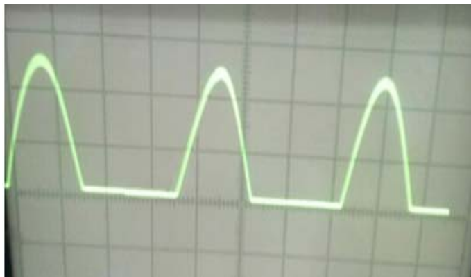
Рисунок 2 – Изменение величины амплитуды тока от времени в сернокислом растворе меди при поляризации импульсным током синусоидального вида (в электрохимическую цепь последовательно соединен диод)
