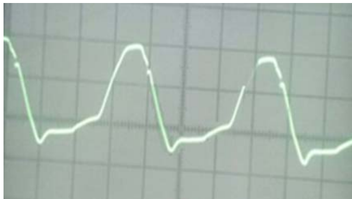
Рисунок 1 – Изменение величины амплитуды тока от времени в сернокислом растворе меди при поляризации переменным током частотой 50 Гц с использованием медного и титанового электрода
