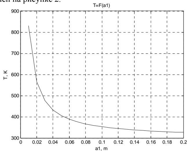
Рисунок 2 – Распределение температуры вдоль радиуса шара
