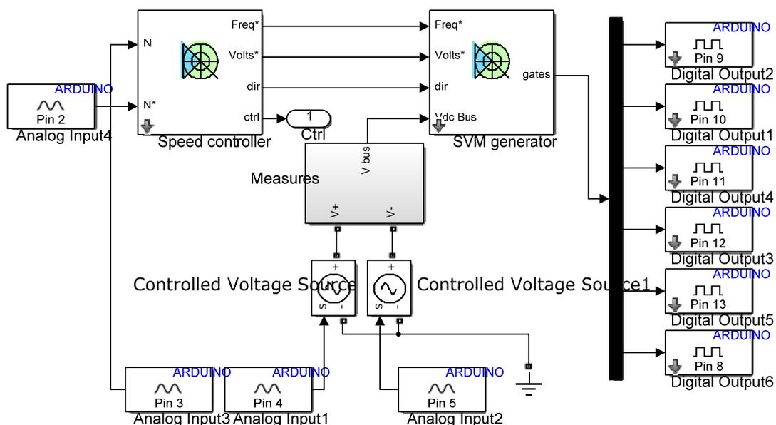
Рисунок 6 – Блок-схема блока управления на платформе Arduino Mega2560
