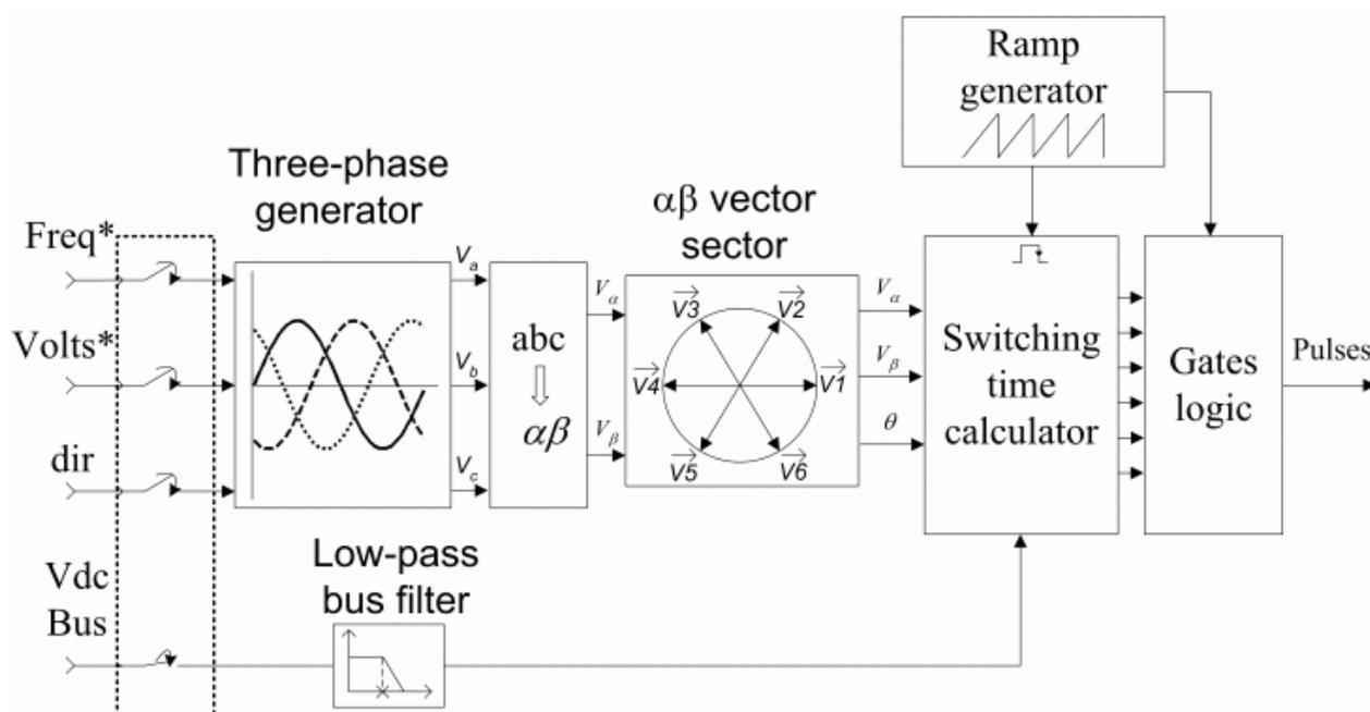
Рисунок 4 – Пространственно-векторный модулятор
