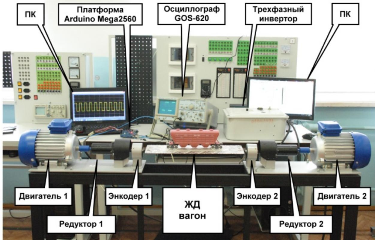
Рисунок 2 – Экспериментальная установка
