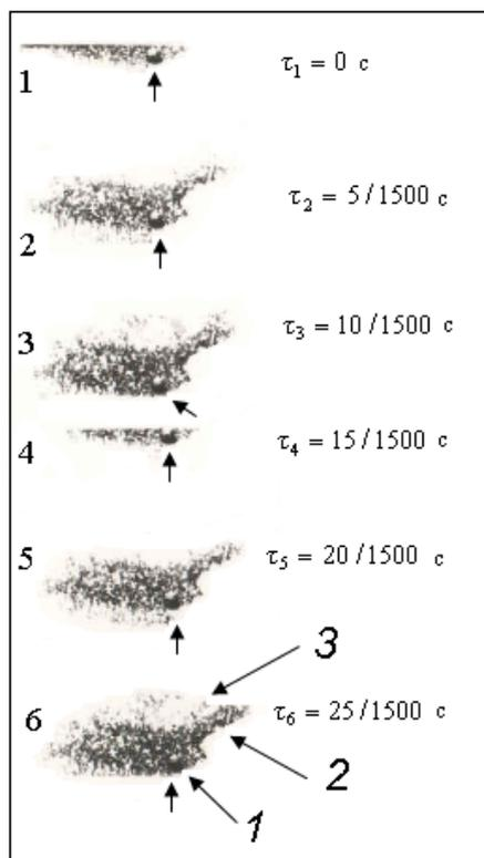
Рисунок 6 – Кинограмма полета частицы (шелушки) размером  $2,5 \cdot 10^{-3}$  м при разрушении тешенитного покрытия горелкой ракетного типа ( $q = 1,2 \cdot 10^6$  Вт/м<sup>2</sup>):
