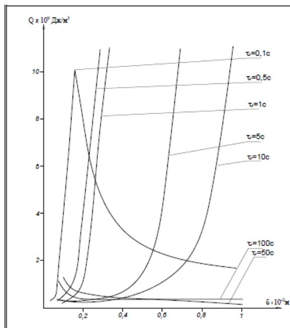
Рисунок 5 – Изменение удельной энергии разрушения покрытия из тешенита в зависимости от  $\delta$  для различных  $\tau$  при  $\sigma_{пр.сж.}/\sigma_{пр.раст.} = 2$ ;  $Q = \frac{q \cdot \tau}{\delta}$
