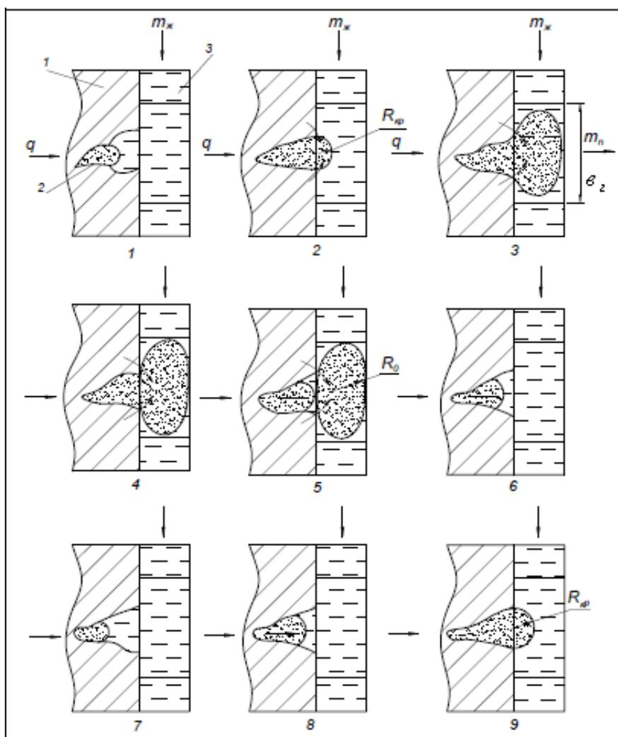
Рисунок 1 – Иллюстрация процесса зарождения, развития и отрыва парового пузыря в активной поре парогенерирующей стенки, покрытой пористой структурой: 1 – стенка; 2 – впадина; 3 – пористая структура;  $q$  – тепловая нагрузка;  $m_{ж}$  – расход жидкости;  $m_{п}$  – расход пара;  $\epsilon_z$  – гидравлический размер структуры
