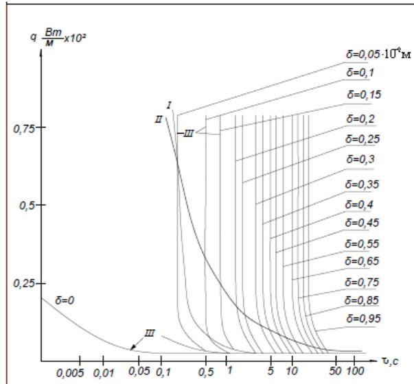
Рисунок 2 – Зависимость тепловых потоков, вызывающих напряжения сжатия тешенитного покрытия в зависимости от времени действия  $\tau$  для различной толщины  $\delta$  отрывающихся частиц:
