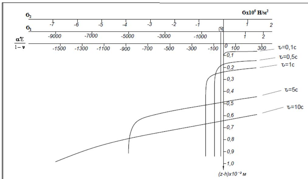
Рисунок 3 – Эпюры напряжений по толщине тешенитовой пластины при различных  $q$  и  $\tau$ :  $q_1 = 6,6 \cdot 10^6$  Вт/м<sup>2</sup>;  $q_2 = 1 \cdot 10^4$  Вт/м<sup>2</sup>; 76 – предел прочности на растяжение
