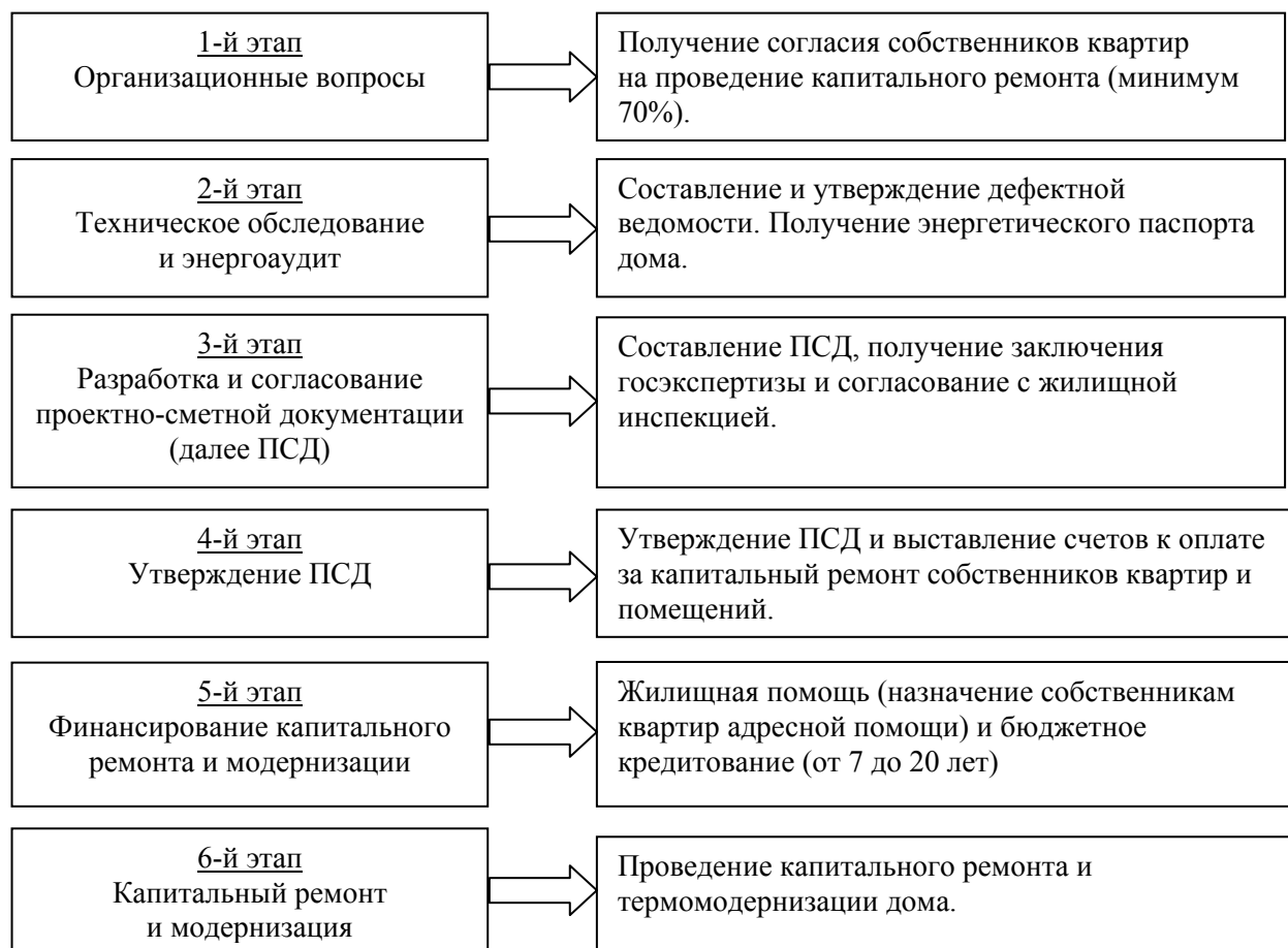
Рисунок 2 – Этапы проведения капитального ремонта и модернизации МЖД
